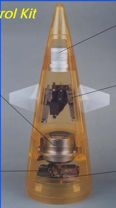
• Thermal Battery • Eagle-Picher • EAP-12155
